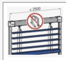
La struttura autoportante della tenda
